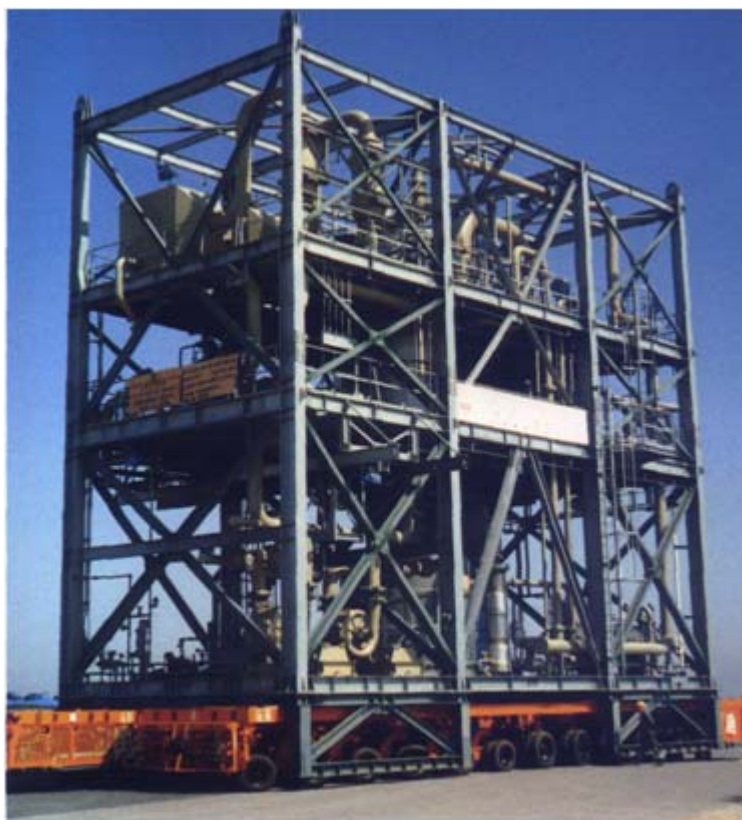
Фигура 4 Мобилна инсталация за изгаряне на течни отпадъци (фирма NCE Inc. – Япония)
