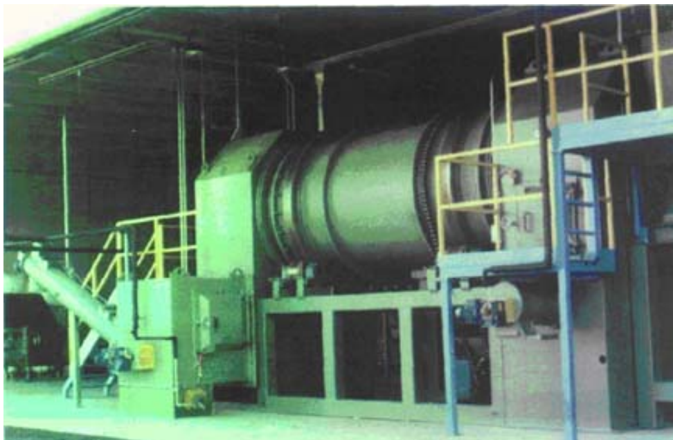
Фигура 1 Ротационна пещ за изгаряне (фирма J. Egli AG)
