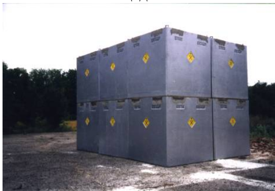
Снимка 18 Разполагане на запълнените контейнери "ББ куб"® на подходяща, отговаряща на нормативните изисквания площадка.
