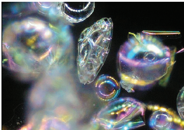
Фигура IV-1. Микроскопски образ на микробалончета образувани от ПВС в горещ газов поток
