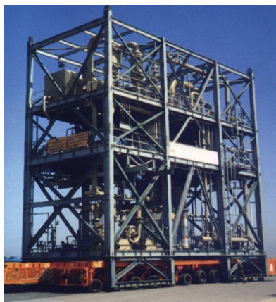
Фигура III-18. Мобилна инсталация за изгаряне на течни отпадъци (фирма NCE Inc. - Япония)
