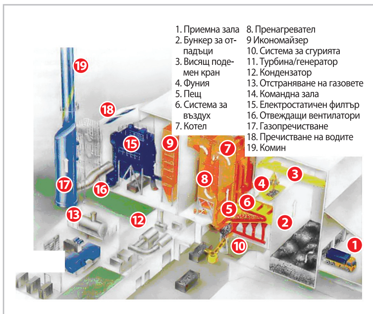
Фигура 11. Принципна технологична схема на инсталация „Масово изгаряне върху подвижна решетка“
